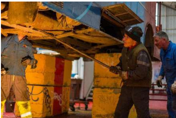
Libération de la fixation de l'arbre de transmission.
