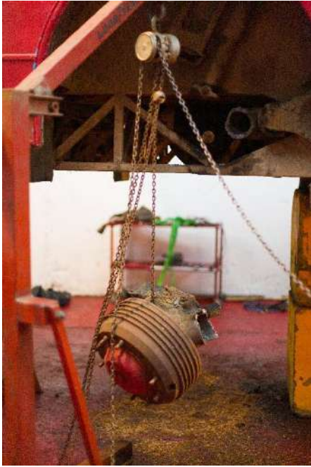
Libération de la fixation de l'arbre de transmission.
